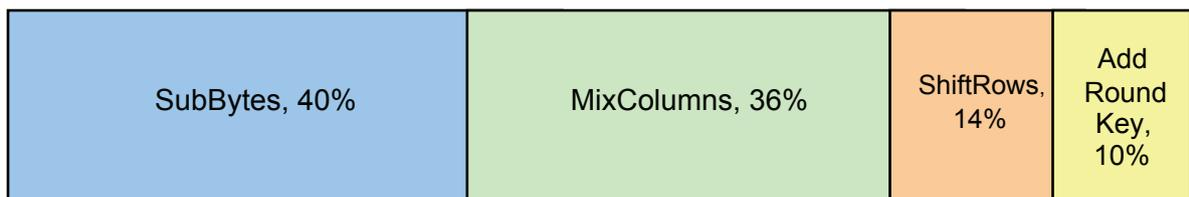
図 19 各モジュールの CPU 処理負荷
