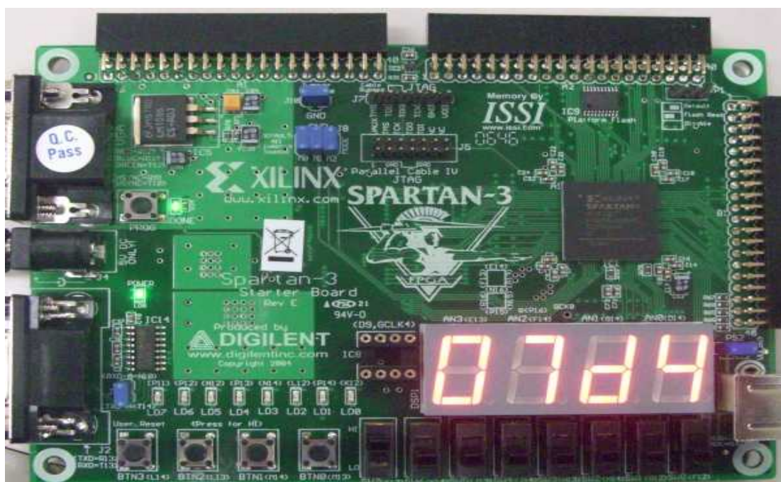
図 8 : 2^{512} - 1 周期 WELL の FPGA への実装
