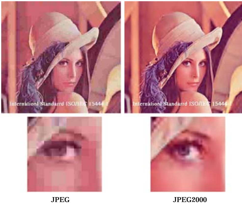
図 6 JPEG と JPEG2000 でエンコードした画像の比較(圧縮率 1%)
